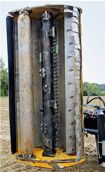
Ant būgno pritvirtinta 18 plaktukinių daužiklių, kurių saugojimui numatytos dėtušės priešais jį arba už jo
